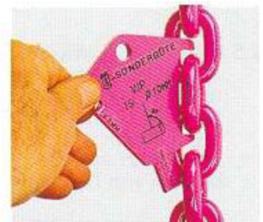
Prüfen Plastische Längung durch Überlast.
