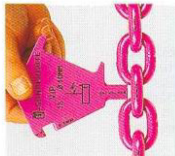
Prüfen Teilungsverlängerung durch Nenndickenverschleiß.
