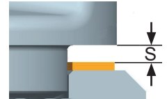
Abb. 4: Abstand zwischen Ober- und Unterteil
