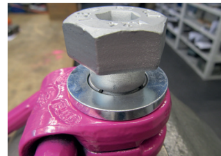
Abb. 9: Sprengring umlaufend vertieft in der Ansenkung positioniert
